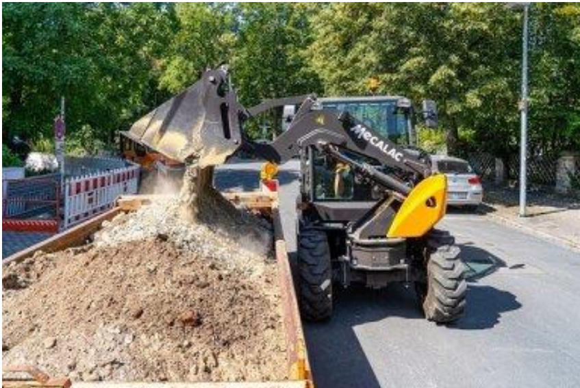
Bild: Quelle Mecalac; Fahrzeug steht in Fahrtrichtung, Ladearm ist seitlich geschwenkt
